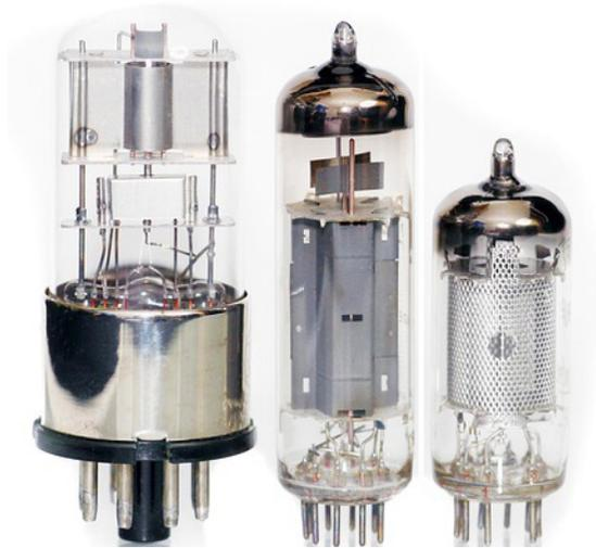
As válvulas, tubos de vidro em que elétrons podiam se mover pelo vácuo, foram substituídas por dispositivos feitos de semicondutores
